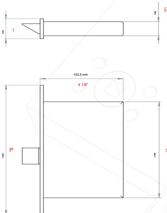
Das PaxLock Pro - Deadbolt Mortise-Schloss ist ein Schlosskasten der Yale 8800-Serie, der für die Verwendung mit dem PaxLock Pro - Mortise modifiziert wurde. Dieser Schlosskasten enthält einen Riegel.
