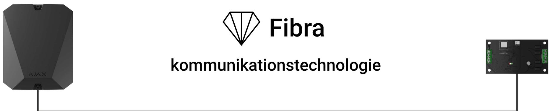
**Fibra ist ein kabelgebundenes Protokoll** für schnelle und sichere Zwei-Wege-Kommunikation zwischen Hub-Zentralen und Geräten. Fibra sendet sofortige Alarmmeldungen mit ausführlichen Informationen: Sicherheitsdienste und Benutzer wissen, welches Gerät wann und wo ausgelöst wurde.
